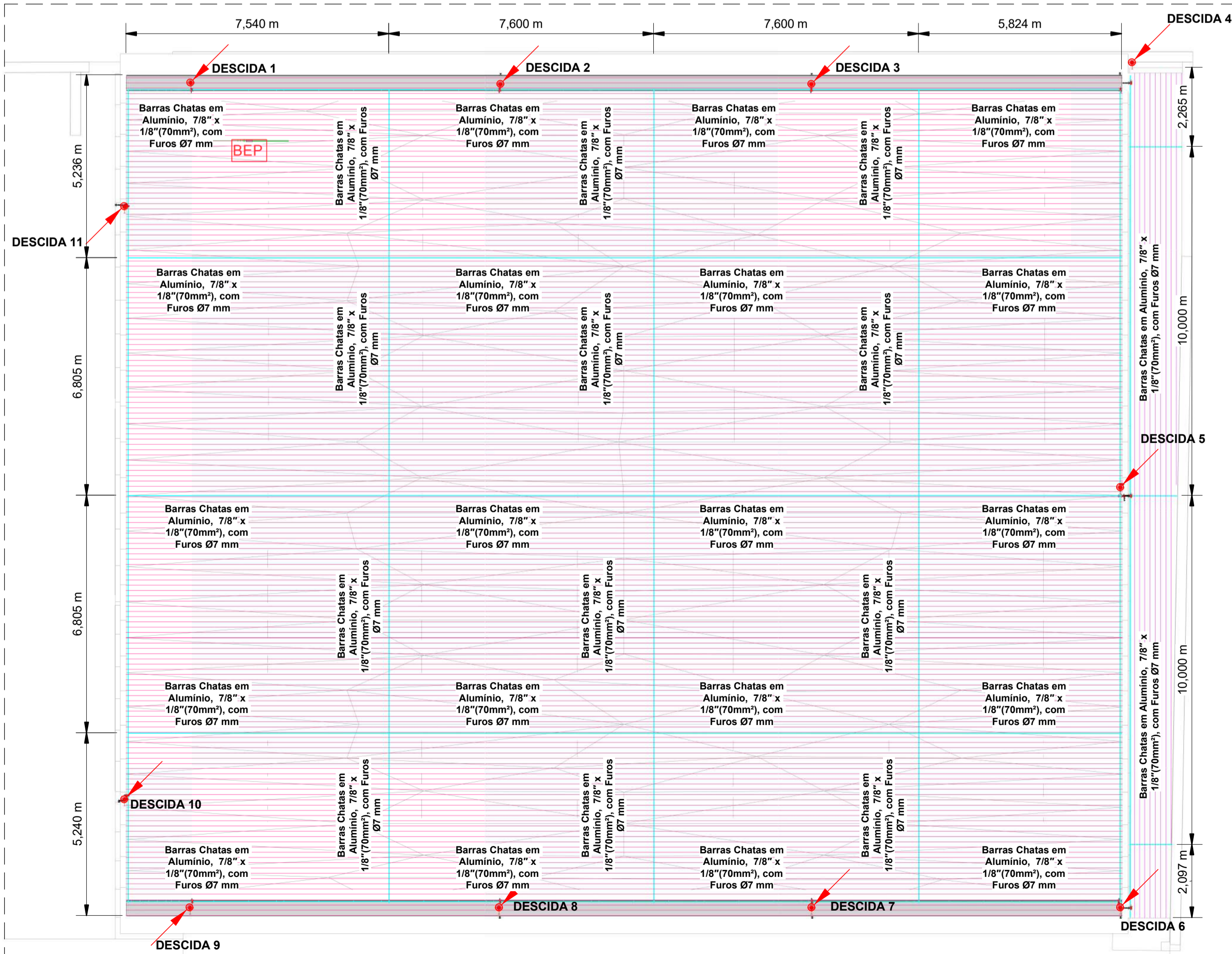
01 PLANTA DE COBERTURA - SISTEMA DE CAPTAÇÃO ESCALA 1:100
